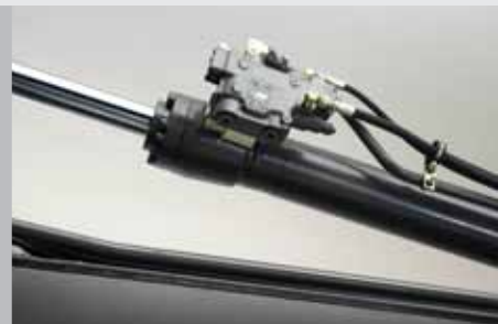
Valve de sécurité en cas de rupture de flexible, balancier
