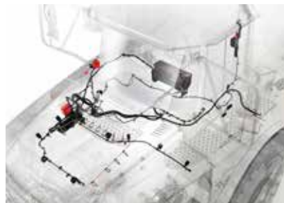
Système de protection contre l'incendie
