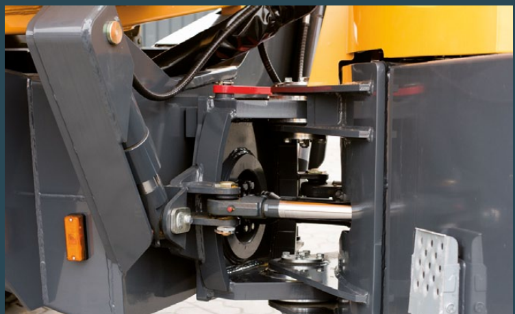
Knick-Pendelgelenk mit Stabilisierungszylinder.
