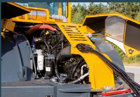
Gute Zugänglichkeit zu allen Wartungsstellen durch patentiertes Haubensystem.
