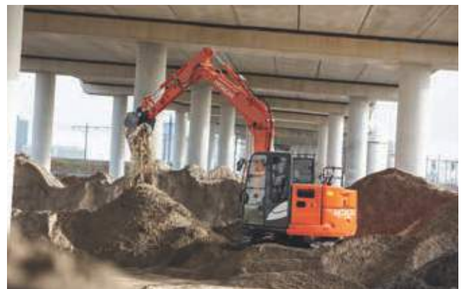
Dank des kleinen Heckschwenkradius ist der ZX85USB-6 ideal für Arbeit auf engem Raum.
