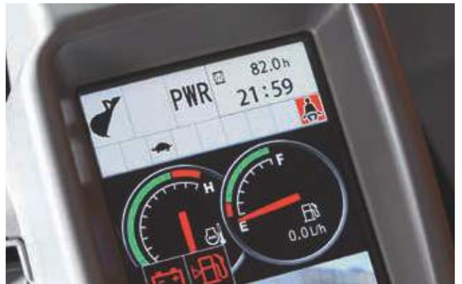
Le grand écran multifonctionnel LCD couleur indique les données nécessaires d'un simple coup d'œil.
