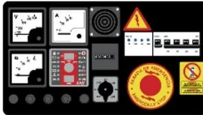
Schaltschrank mit manuellem Start durch freien Spannungskontakt und vier- oder zweipoligem thermomagnetischem Schutzschalter (je nach elektrischer Spannung) sowie Differentialrelais.
