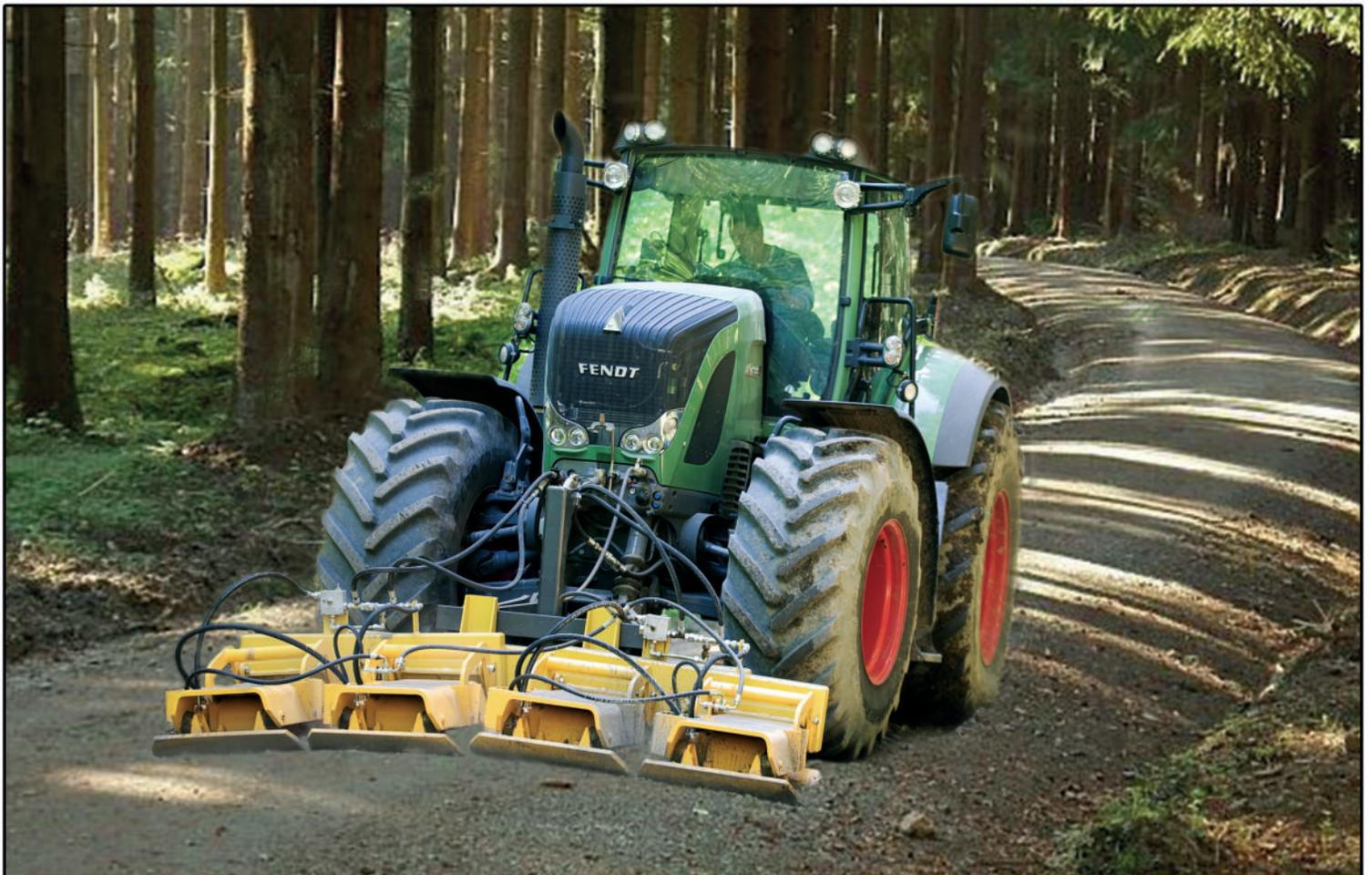
Anhängeplanier Vorrichtung für Traktoren ab 7,5 to. !!
