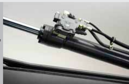
Valve de sécurité en cas de rupture de flexible, balancier
