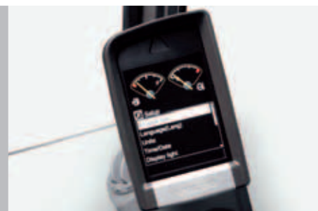
Hammer und Scherenhydraulik: variable Fördermenge und Druckvoreinstellung
