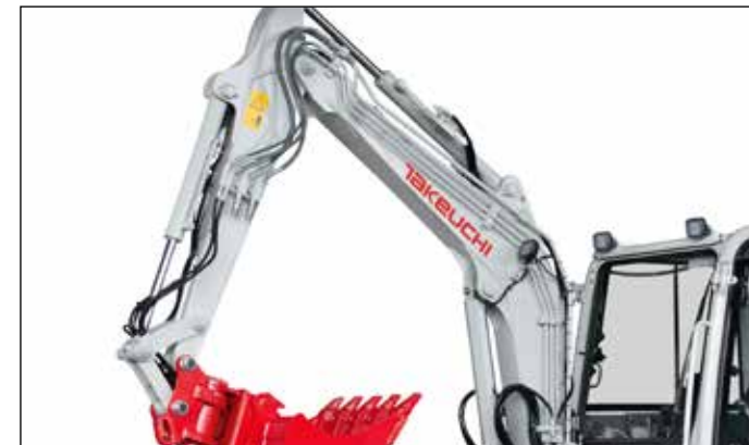
4 circuits auxiliaires dont 3 réglés proportionnellement avec réglage de puissance.
