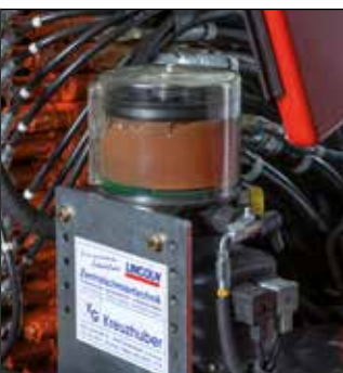
Système de graissage centralisé avec indicateur de remplissage
