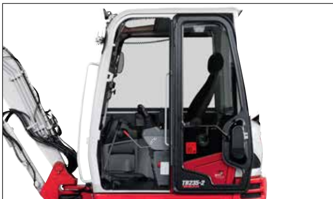
Cabine spacieuse et confortable, insonorisée et anti-vibrations avec compartiments de rangement. Large accès avec porte massive. Vitre frontale repliable vers le haut.
