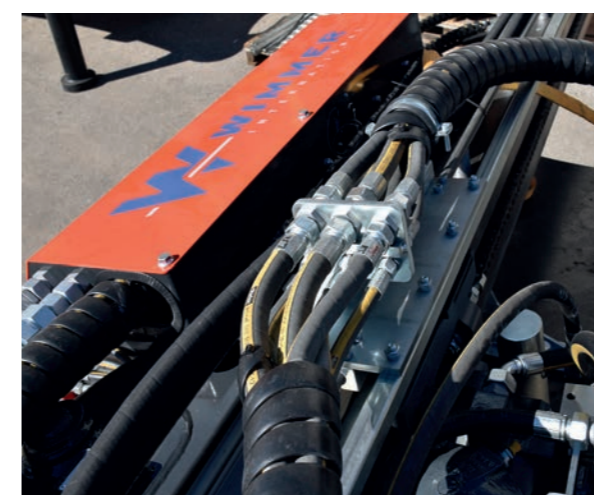
Pour le forage tubé : Le dispositif de serrage/déserrage sert à raccorder et à déconnecter les tubes
