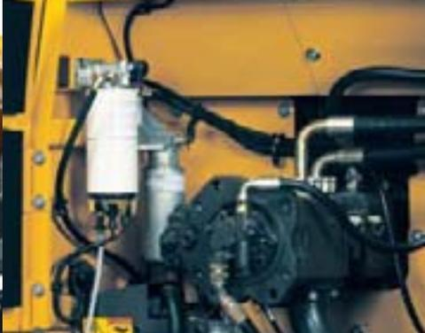
• Accès commode aux pompes hydrauliques et aux filtres.
