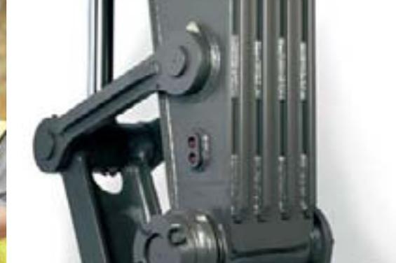
• Balancier protégé avec fixation de godet renforcée, en option.
