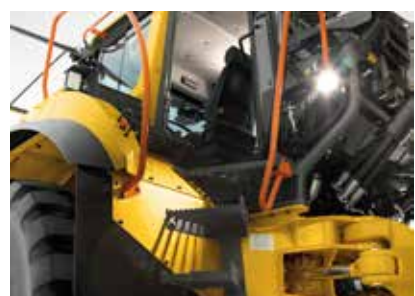
Eclairage de l'accès à la cabine
