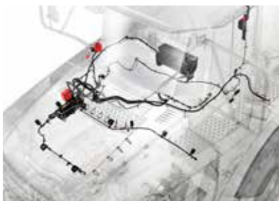
Système de protection contre l'incendie Volvo
