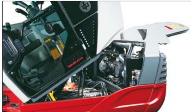
Cabine basculante pour accès optimal au moteur et à l'ensemble des composantes
