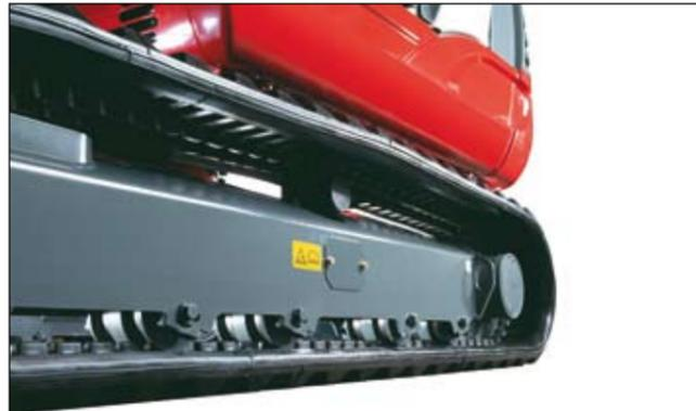
Des galets de roulement à double guidage sûr et précis des chenilles. Chaînes en caoutchouc à pas court (Short-Pitch) pour un confort d'utilisation avec peu de vibration
