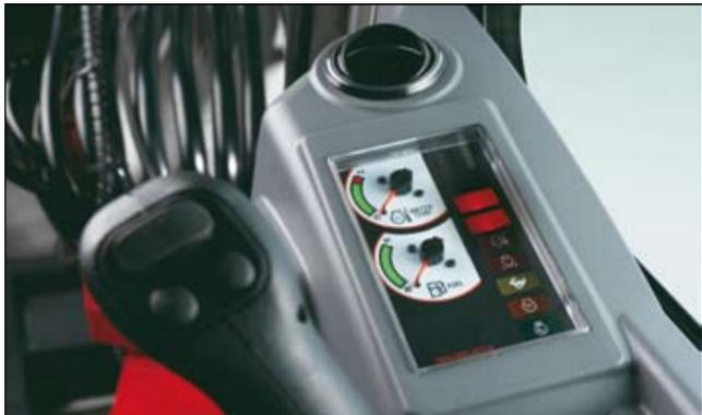
Tableau de bord clair avec témoins de contrôle et sécurité d'arrêt automatique en cas d'anomalie
