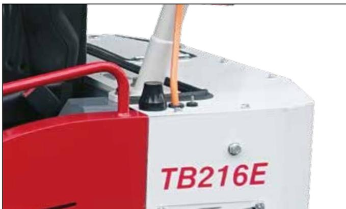
Antenne WIFI/GPRS. Sert d'interface de service. En cas de besoin, les dysfonctionnements peuvent être analysés et éliminés à distance.
