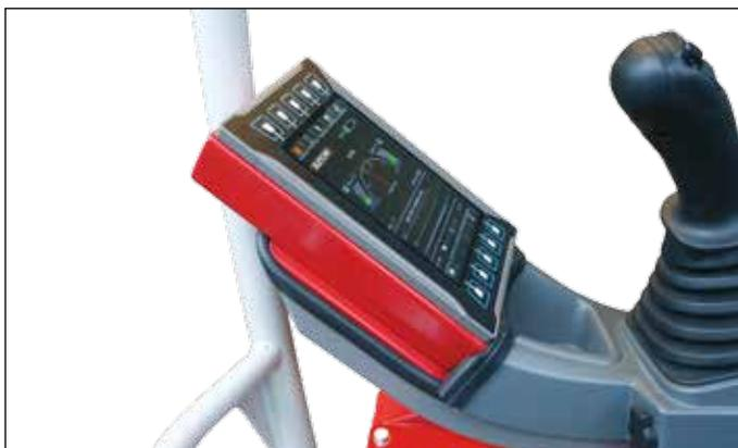
Tablette avec menu intuitif. Fonctions : notamment régime de la pompe hydraulique, état de charge de la batterie, température du moteur.
