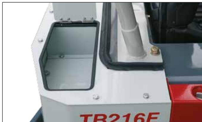
Boîte verrouillable pour ranger les outils et les câbles d'adaptateur.
