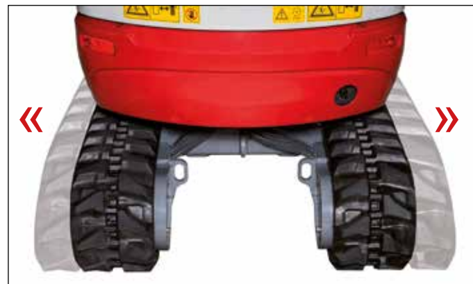
Train de roulement avec un élargissement hydraulique du châssis.
