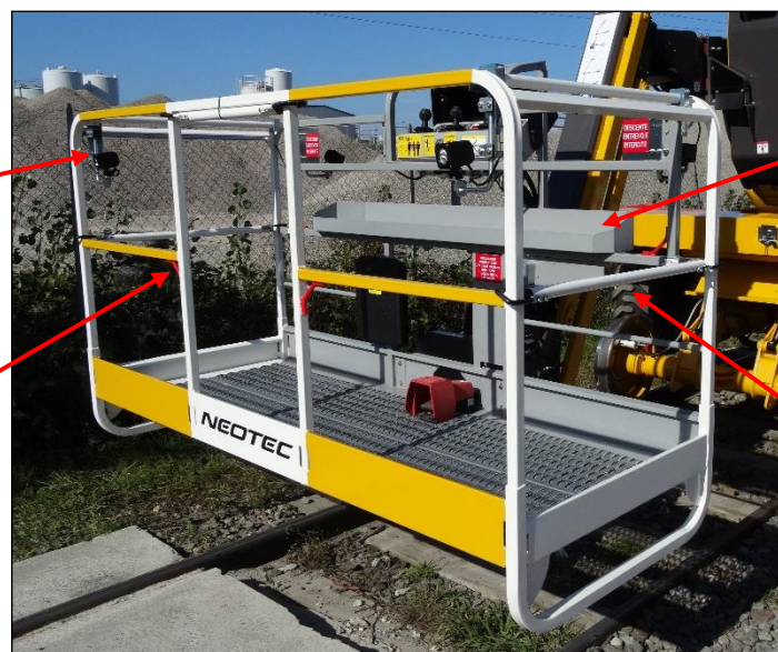
Poste de commande dans le panier avec afficheur de données et écran de recul
