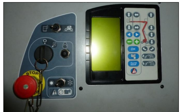
Poste de commande sur tourelle
