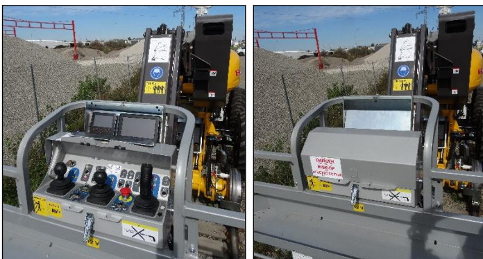
Poste de commande dans le panier avec afficheur de données et écran de recul
