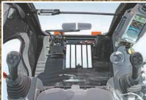
La vitre intégrée au plancher de la cabine offre une meilleure visibilité du chantier sous l'engin.
