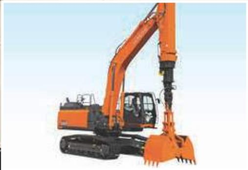
Le bras télescopique se déploie et se rétracte en douceur à pleine charge.
