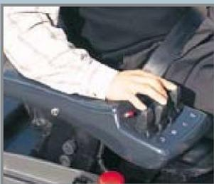
Valve de commande hydraulique Finger- Tip (3 fois, 4 fois)
