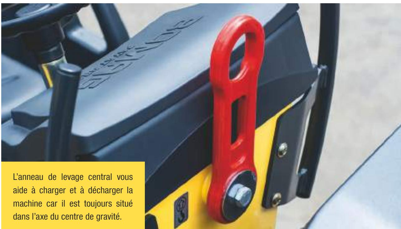
L'anneau de levage central vous aide à charger et à décharger la machine car il est toujours situé dans l'axe du centre de gravité.
