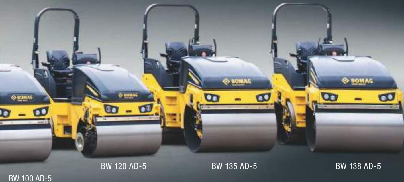
**Des rouleaux tandems légers pour le compactage de la terre et de l'asphalte.**
