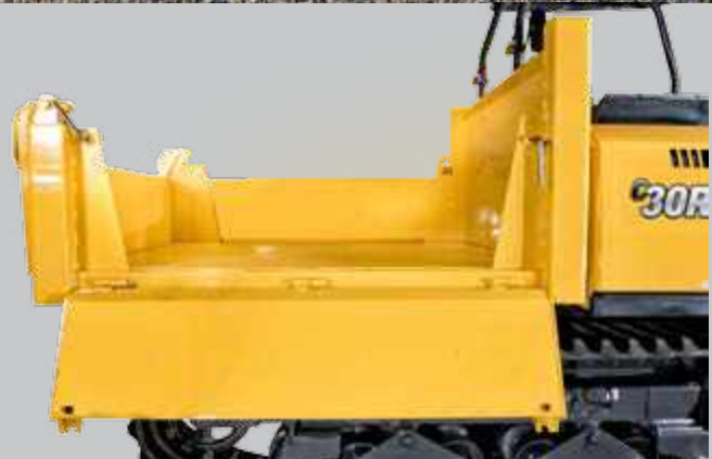
Wagen mit drei Seitenklappen mit Heckkipfung
