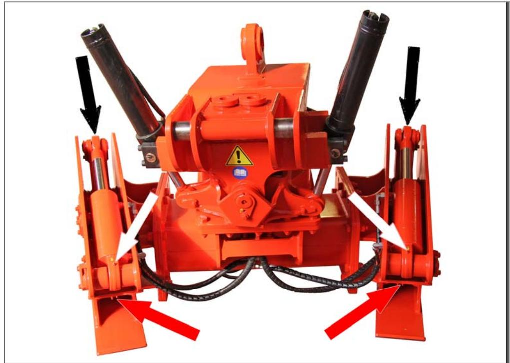
Abb. 7: Schmierstellen Zylinder/ Täglich
