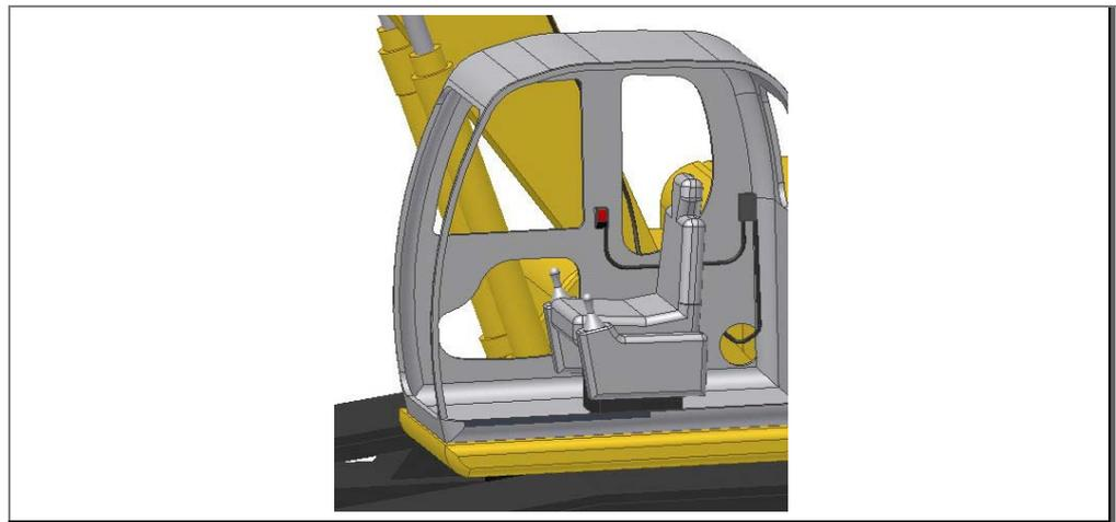
Abb. 3: Position Schalter „Greifer öffnen“
