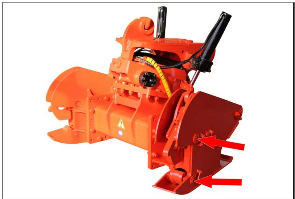
Abb. 8: Schmierstellen Bolzen/ Täglich
