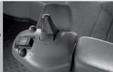
Komfort-Lenk- und Fahrschaltung (CDC - Comfort Drive Control)
