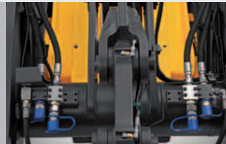
Hydraulik, 3. und 4. Funktion
