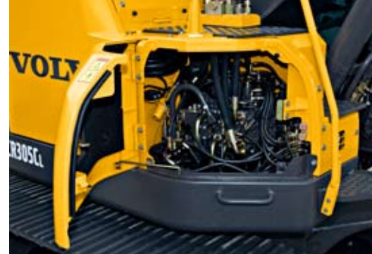
• Große Serviceöffnung – vom Boden aus leicht zugängliche Hydraulikventile.
