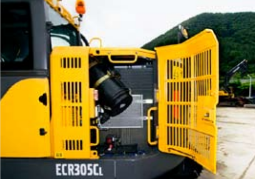
• Zugang zum Motorluftfilter vom Boden aus.
