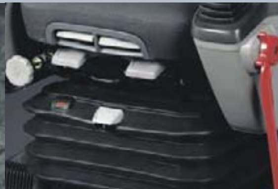
• Der robust gefederte Fahrersitz – eine Wohltat für den ganzen Körper.
