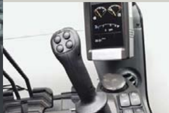
• LCD-Farbmonitor und Bedienelemente – ergonomisch günstig angeordnet.
