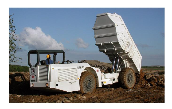
PAUS - Muldenkipper ITC 10000, durch einen Dieselmotor angetrieben, knickgelenktes Fahrgestell mit Allradantrieb und Wendesitz
