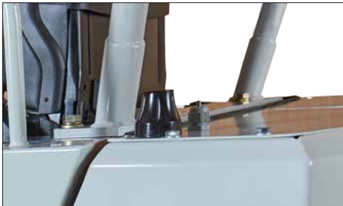
WLAN / GPRS Antenne. Dient als Serviceschnittstelle. Im Bedarfsfall können Störungen aus der Ferne analysiert und behoben werden.
