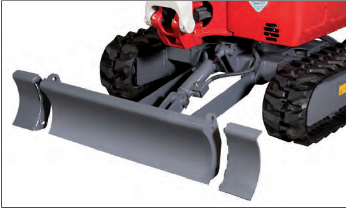
Langes Planierschild aus verwindungsfreiem Stahl mit manueller Verbreiterung.
