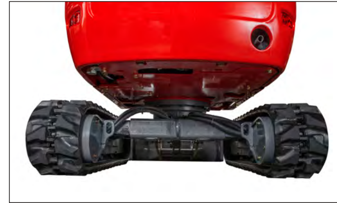
Grosse Bodenfreiheit, geschlossener und daher besonders geschützter Unterwagen.
