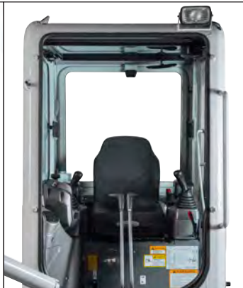
Fahrerschutzdach mit ROPS (ISO12117-2), TOPS (ISO12117), OPG (ISO10262 Stufe1) und Komfortsitz (wetterfeste Ausführung) mit Sicherheitsgurt.
