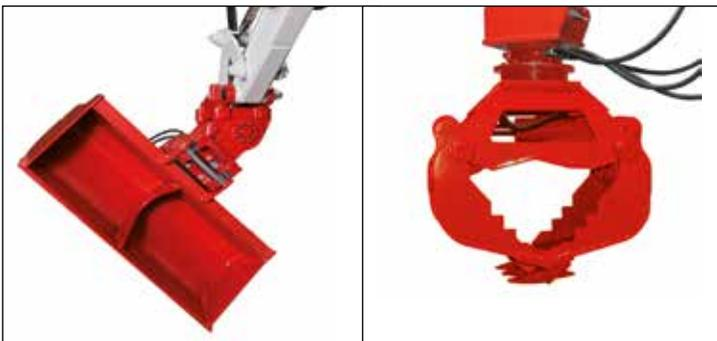
Starrer Grabenräumlöffel mit Powertilt-Schwenvorrichtung
