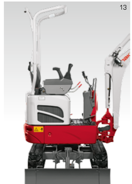
MIN. HECKÜBERSTAND BEI LAUFWERKSBREITE 1.020 MM
