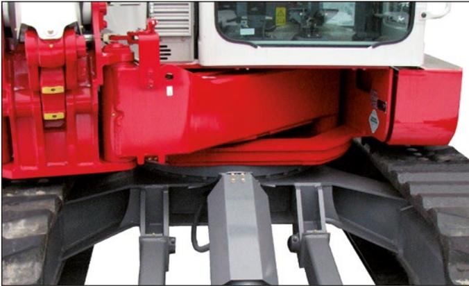
Von TAKEUCHI patentierter, äußerst robust ausgeführter Ausleger-Seitenvershub.
