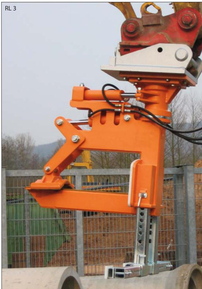
Der hydraulische Rohrleger ist zum Transport und zur Verlegung von Rohren bis zu einem Gewicht von 3.000 kg konzipiert.
