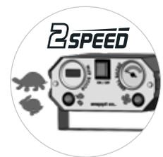
Armaturenkonsole mit Steuerung zum Wechsel der Motoren-Drehzahl und zur Kontrolle der Öltemperatur
