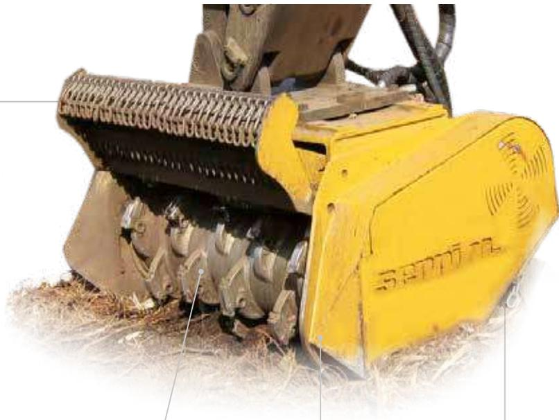
Materialabweiser am Keilriemenkasten
