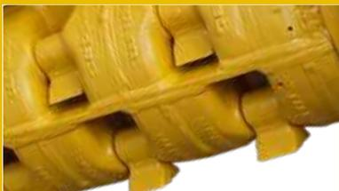
**Rotor mit schwingenden Werkzeugen, wahlweise mit Hartmetalleinsätzen**
