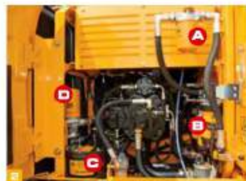
(A) Hydraulikölfilter (B) Kraftstofffilter (C) JCB Plexis-Ölfiltersystem (D) Motorölfilter
