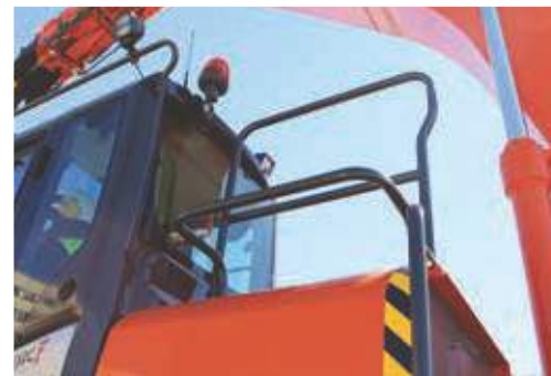
Eine lange Trittstufe und die Haltegriffe ermöglichen stets einen sicheren Zugang zur Kabine.
