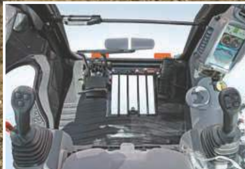
Ein Fenster im Boden der Kabine erlaubt eine bessere Sicht auf den Arbeitsbereich darunter.
