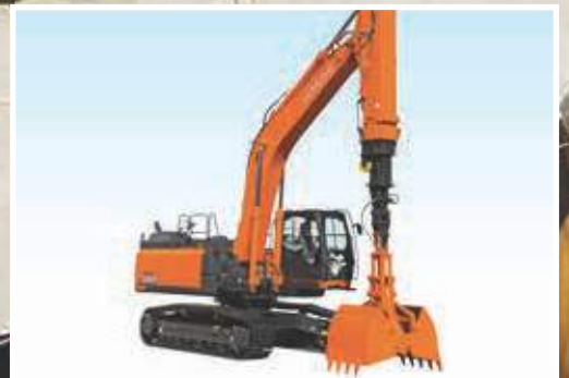
Der Teleskopstiel lässt sich auch bei voller Beladung aus- und einfahren.
