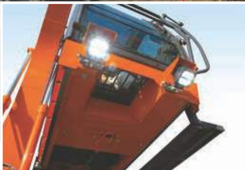
Die optionalen LED-Scheinwerfer leuchten den Arbeitsbereich für den Maschinenführer aus.
