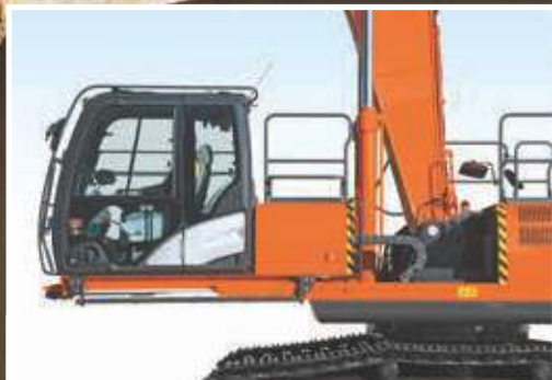
Die nach vorne verschiebbare Kabine sorgt für eine optimale Rundumsicht und verbessert somit die Sicherheit erheblich.
