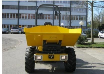
Der neue Raddumper SW4.5 wurde von NC Engineering speziell für den Schweizer Markt entwickelt und gebaut. Der PS (46,5 kW) Motor in Verbindung mit dem zweistufigen hydrostatischen Fahrantrieb sorgt für Kraft im Gelände und eine maximale Geschwindigkeit von 27 km/h. Der neu entwickelte Partikelfilter mit der speziellen LowTemp Beschichtung regeneriert bereits bei tiefen Abgastemperaturen und benötigt keine Additive. Er wird im Werk montiert und ist auf die Motorleistung optimiert.
