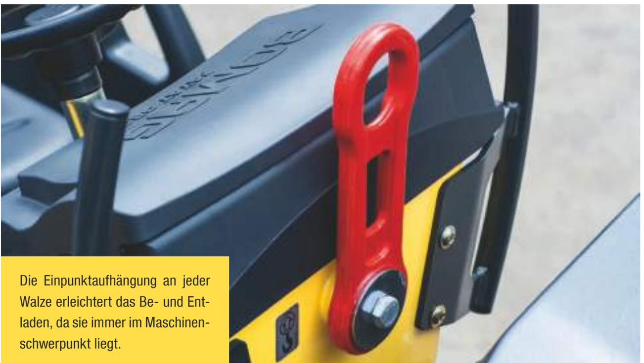
Die Einpunktaufhängung an jeder Walze erleichtert das Be- und Entladen, da sie immer im Maschinenschwerpunkt liegt.
