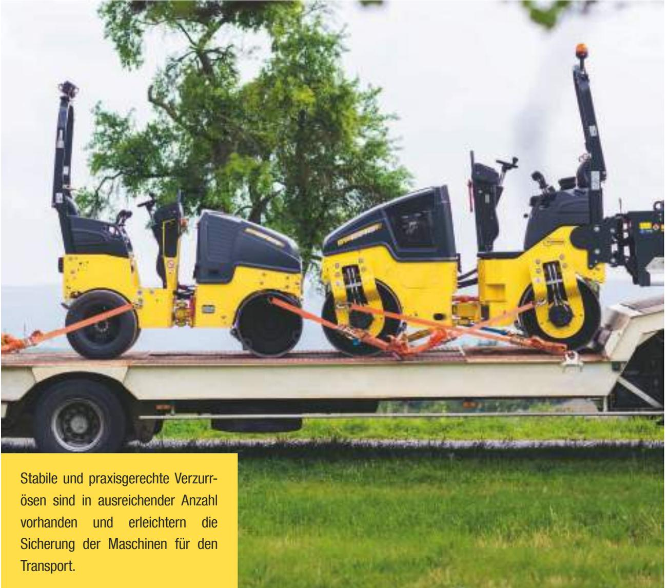
Stabile und praxisgerechte Verzurrösen sind in ausreichender Anzahl vorhanden und erleichtern die Sicherung der Maschinen für den Transport.
