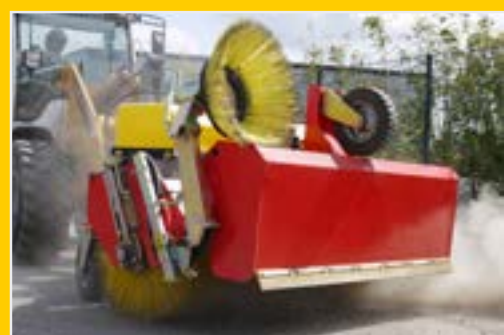
Freikehrrmodus und 750 mm Bürstendurchmesser serienmäßig
