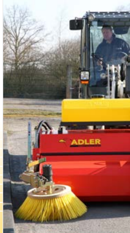
Seitenkehrbesen und Wassertank 240 l als Option
