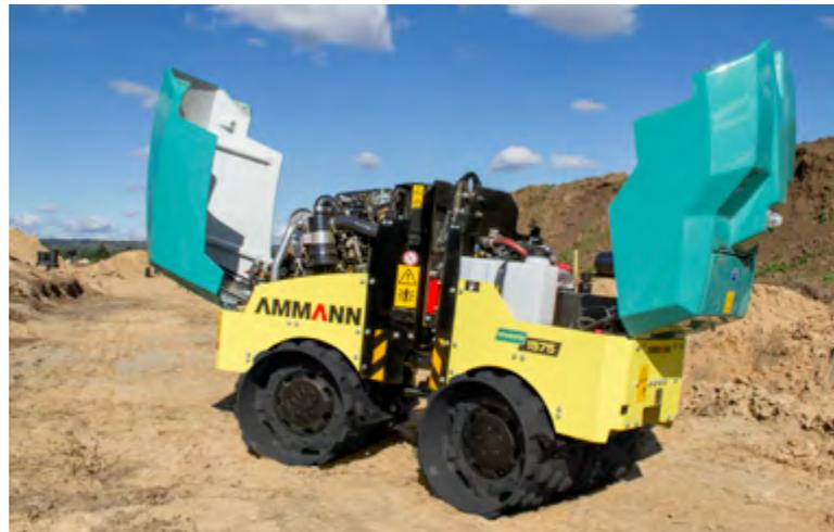
**“Die Haube lässt sich weit öffnen, um einen einfachen Zugriff auf erforderliche Servicepunkte und -Komponenten für das Bedienungspersonal und technische Mitarbeiter zu gewährleisten.”**
