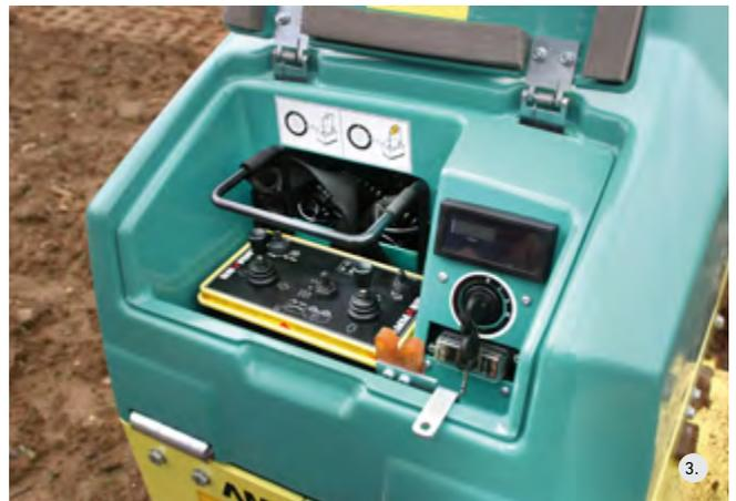
1. INFRAROT-FERNSTEUERUNG ARR 1575, RAMMAX 1575
