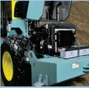
Zugänglichkeit des Motors und der Batterie
