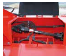
Zugzug zu den Ambossplatten und Wartung der Gelenkwelle und des oberen Lagers
