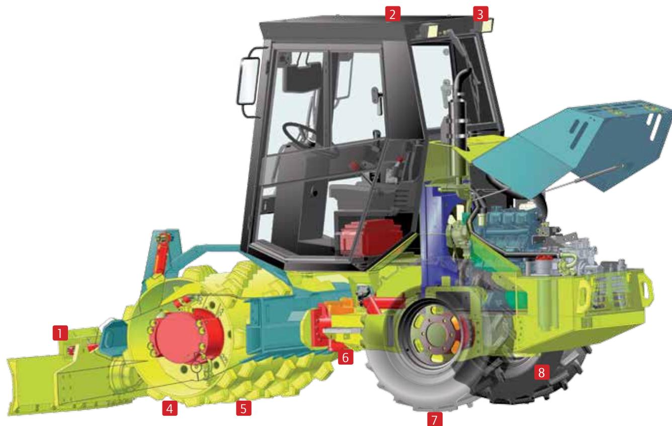
1. Lame de nivellement hydraulique avec fonction inclinaison et position „flottante”
